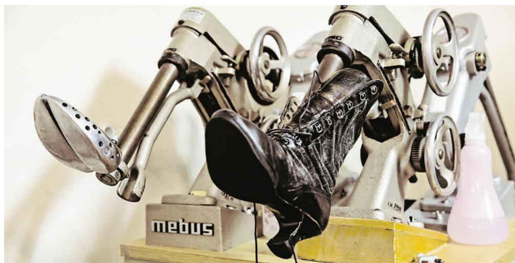
Ein Schaftspanner kann einen Schuh dehnen. Zudem können in die Löcher metallene Erhebungen gesteckt werden, um einzelnen Druckstellen oder die Stelle eines Hallux zu weiten.
