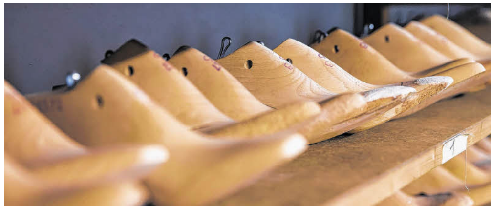
Unbearbeitete Leisten. Um einen Fuß nachzubauen, werden sie mit Kork oder Leder besetzt.
