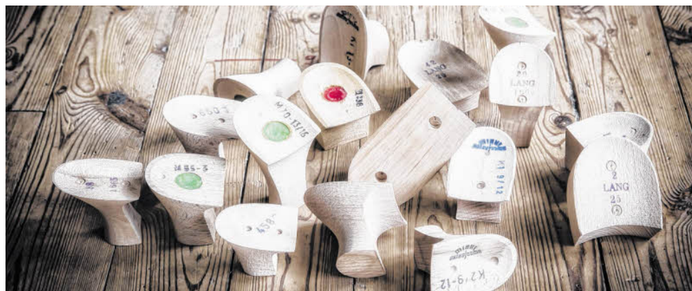
Diverse Absätze aus Holz. Sie werden bei Bedarf mit Stoff überzogen oder bemalt.
